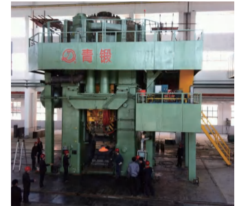
EPC-8000 型 80MN 电动螺旋压力机
