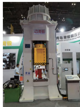
EP-400A 型 4000kN 直驱式电动螺旋压力机
