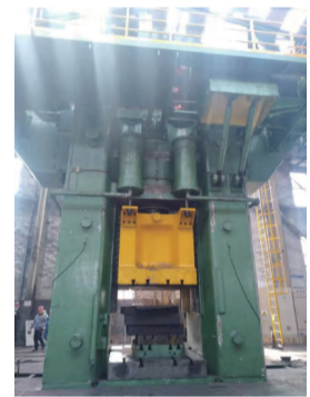
FCP-16000 型 160MN 重型数控摩擦螺旋压力机正面视图
