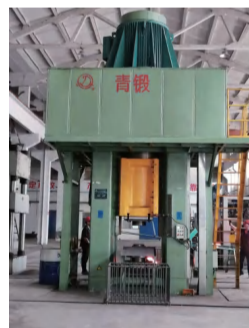
EP-1600Z 型 16000kN 直驱式数控电动螺旋压力机
