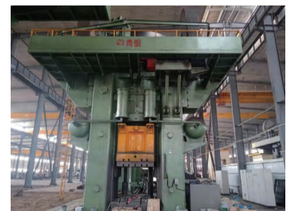
FCP-18000 型 180MN 重型数控摩擦螺旋压力机
