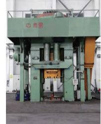
EPC-4000 型 40000kN 电动螺旋压力机 3.FCP 系列重型数控摩擦螺旋压力机
