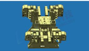
步进梁运输机简称步进梁,它在现代化的热,冷轧带钢车间和带钢处理线车间是常用的工艺设备之一。步进梁一般被布置在生产线的入口段或出口段,完成钢卷的输入或输出任务。根据工艺的要求,步进梁与其周围有关的设备协同工作,实现钢卷的宽度和直径测量、拆捆带、对中、称重、打捆等等。其结构和工作原理决定了它可以与车间的吊运设备很好地配置,来实现生产的快节奏、高产量和生产的自动化。
