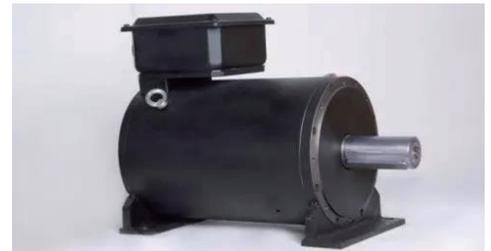
产品简介：产品采用液体冷却（水或油），环境影响小，使用可靠；小惯量，高刚性，实时响应负载变化，能耗低，高效节能；全转速范围，恒扭矩平稳传动，转速精度高；结构紧凑，体积小，比同功率异步电机小两个基座号；转矩范围 2Nm ~ 100000Nm，额定转速 200-500-1500rpm。
